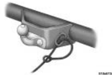
LESZERELHETŐ VONÓFEJRE TÖRTÉNŐ HURKOLÁSOS ÉS CSÍPTETÉSES MÓDSZER
