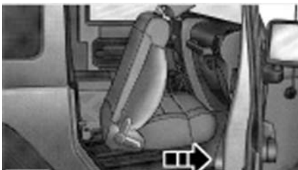
AZ ÜLÉS BESZÁLLÁST SEGÍTŐ FUNKCIÓJA KOMBINÁLT KAR ESETÉN - EGYES VÁLTOZATOKNÁL
