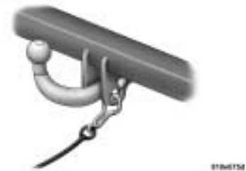
FIX VONÓFEJRE TÖRTÉNŐ HURKOLÁSOS ÉS CSÍPTETÉSES MÓDSZER
