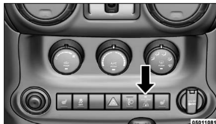
A STOP/START OFF [STOP/START KI] KAPCSOLÓ
