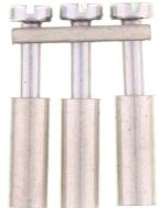
Querverbindrer, Polzahl: 3, Montageart: Schraubbar, Breite: 17 mm, Bemessungsquerschnitt: 4 mm<sup>2</sup>, Farbe: Natur
