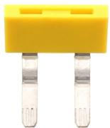
Aussenquerverbindner isoliert, Polzahl: 2, Montageart: Stecken, Breite: 16,1 mm, Bemessungsstrom: 27 A, Farbe: Gelb
