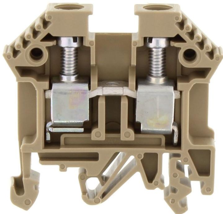
Durchgangsklemme, Schraubanschluss, Montageart: TS 35/7,5 und TS 32, Bemessungsquerschnitt: 10 mm<sup>2</sup>, Breite: 8 mm, Farbe: Beige
