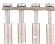
Querverbinder, Polzahl: 4, Montageart: Schraubbar, Breite: 30,3 mm, Bemessungsquerschnitt: 10 mm<sup>2</sup>, Farbe: Natur
