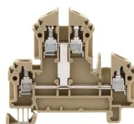
Doppelstockklemme, Schraubanschluss, Montageart: TS 35/7,5, Bemessungsquerschnitt: 4 mm<sup>2</sup>, Breite: 6 mm, Farbe: Beige
