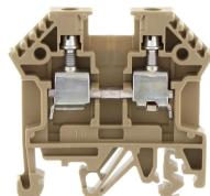
Ex-Durchgangsklemme zertifiziert nach ATEX, Schraubanschluss, Montageart: TS 35/7,5 und TS 32, Bemessungsquerschnitt: 4 mm<sup>2</sup>, Breite: 6 mm, Farbe: Beige
