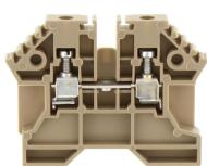
Durchgangsklemme zur Direktmontage/Blockvariante, Schraubanschluss, Montageart: Montagefläche, Bemessungsquerschnitt: 2,5 mm<sup>2</sup>, Breite: 5 mm, Farbe: Beige
