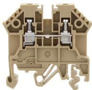
Ex-Durchgangsklemme zertifiziert nach ATEX, Schraubanschluss, Montageart: TS 35/7,5 und TS 32, Bemessungsquerschnitt: 2,5 mm<sup>2</sup>, Breite: 5 mm, Farbe: Beige
