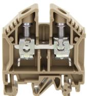
Ex-Durchgangsklemme zertifiziert nach ATEX, Schraubanschluss, Montageart: TS 35/7,5 und TS 32, Bemessungsquerschnitt: 16 mm<sup>2</sup>, Breite: 12 mm, Farbe: Beige
