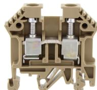
Ex-Durchgangsklemme zertifiziert nach ATEX, Schraubanschluss, Montageart: TS 35/7,5 und TS 32, Bemessungsquerschnitt: 10 mm<sup>2</sup>, Breite: 8 mm, Farbe: Beige
