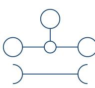
Durchgangsklemme, Schraubanschluss, Montageart: TS 35/7,5 und TS 32, Bemessungsquerschnitt: 25 mm<sup>2</sup>, Breite: 5 mm, Farbe: Beige
