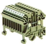
Durchgangsklemme/Blockvariante, Schraubanschluss, Montageart: TS 35/7,5 und TS 32, Bemessungsquerschnitt: 2,5 mm<sup>2</sup>, Farbe: Beige
