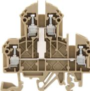
Doppelstockklemme, Schraubanschluss, Montageart: TS 35/7,5 und TS 32, Bemessungsquerschnitt: 2,5 mm<sup>2</sup>, Breite: 5 mm, Farbe: Beige
