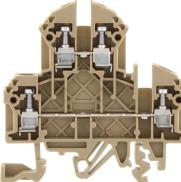
Ex-Doppelstockklemme zertifiziert nach ATEX, Schraubanschluss, Montageart: TS 35/7,5 und TS 32, Bemessungsquerschnitt: 2,5 mm<sup>2</sup>, Breite: 5 mm, Farbe: Beige
