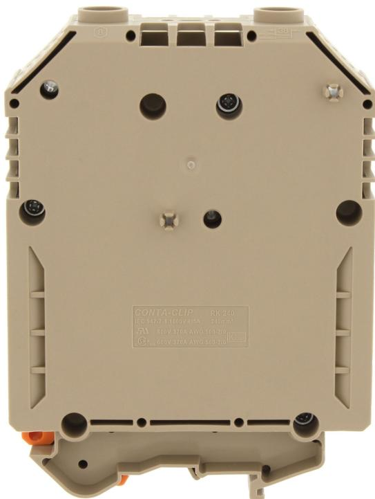
Durchgangsklemme, Schraubanschluss, Montageart: TS 35/7,5 und TS 32, Bemessungsquerschnitt: 240 mm<sup>2</sup>, Breite: 36 mm, Farbe: Beige
