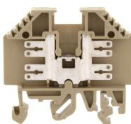
Durchgangsklemme, Faston Flachsteckanschluss, Montageart: TS 35/7,5 und TS 32, Breite: 6 mm, Farbe: Beige
