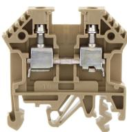
Durchgangsklemme, Schraubanschluss, Montageart: TS 35/7,5 und TS 32, Bemessungsquerschnitt: 4 mm<sup>2</sup>, Breite: 6 mm, Farbe: Beige
