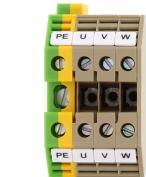
Vierleiter-Motor-Anschlussblock, Schraubanschluss, Montageart: TS 35/7,5 und TS 32, Bemessungsquerschnitt: 4 mm<sup>2</sup>, Farbe: Mehrfarbig
