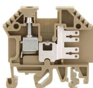
Durchgangsklemme, Faston Flachsteckanschluss / Schraubanschluss, Montageart: TS 35/7,5 und TS 32, Bemessungsquerschnitt: 2,5 mm<sup>2</sup>, Breite: 6 mm, Farbe: Beige
