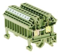
Durchgangsklemme/Blockvariante, Schraubanschluss, Montageart: TS 35/7,5 und TS 32, Bemessungsquerschnitt: 4 mm<sup>2</sup>, Farbe: Beige
