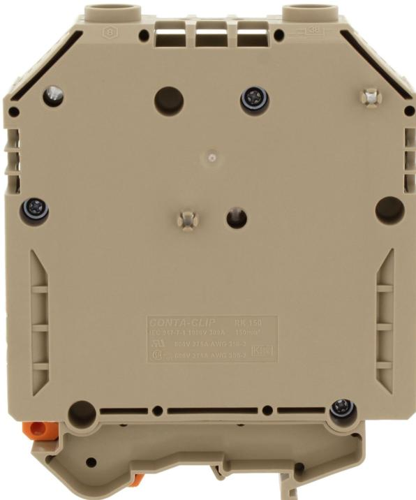
Durchgangsklemme, Schraubanschluss, Montageart: TS 35/7,5 und TS 32, Bemessungsquerschnitt: 150 mm<sup>2</sup>, Breite: 31 mm, Farbe: Beige
