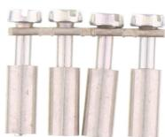
Querverbindrer, Polzahl: 4, Montageart: Schraubbar, Breite: 19,3 mm, Bemessungsquerschnitt: 2,5 mm<sup>2</sup>, Farbe: Natur
