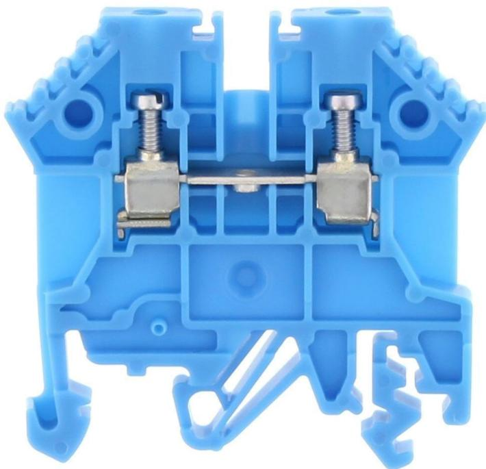
Durchgangsklemme, Schraubanschluss, Montageart: TS 35/7,5 und TS 32, Bemessungsquerschnitt: 2,5 mm<sup>2</sup>, Breite: 5 mm, Farbe: Blau
