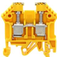
Durchgangsklemme, Schraubanschluss, Montageart: TS 35/7,5 und TS 32, Bemessungsquerschnitt: 10 mm<sup>2</sup>, Breite: 8 mm, Farbe: Schwarz-gelb
